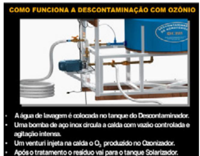
*Imagem 02 - Sistema de Tratamento de Efluente (ilustrativo)*
